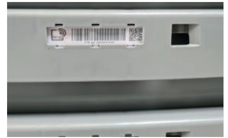
RFID-Aufnahme im oberen Rand
