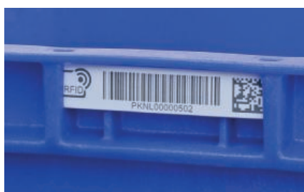
Aufnahme für RFID-Tags (Track & Trace)
